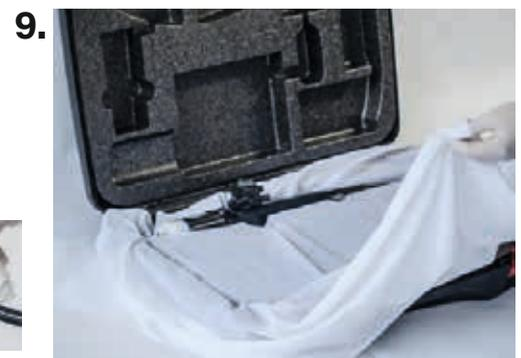
9. Lagerung und Transport des Endoskops im Koffer oder Wanne auf einer Schutzeinlage. Verwenden Sie einen Tupfer für die Endoskopspitze zur Aufnahme der Restfeuchtigkeit.
