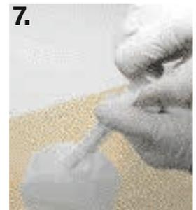
7. Befüllen der Spritze mit Alkohollösung
